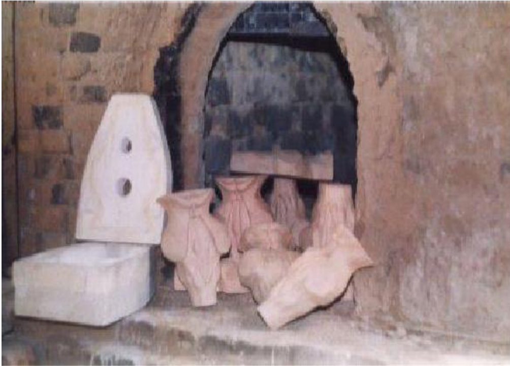
Figura 1. Horno donde se cocinaron modelos tridimensionales, que formaron parte del sistema de medios de enseñanza, a la entrada del mismo se observan los primeros modelos que se obtuvieron y a su izquierda, de color blanco por estar constituido por yeso, el molde donde se obtuvo cada uno de los modelos antes de ser llevado al horno.
